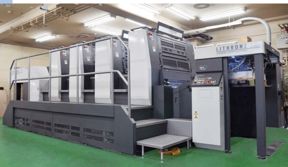
左：リスロンG37は現在、1件1万程度の規模の案件を主流にしており、昼夜で合計で10万ほど通している。 下：H-UV対応化以降、K-サプライインキ「KG-911」を使用。製品のさらなる品質向上につながっている。
