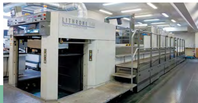
PQA-S V5を導入したリスロンS40は、作業効率の向上だけでなく、不良品の原因追求や予防対策にも貢献している。
